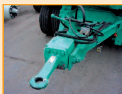
Wechselzugöse für Baumaschinenanhangung
