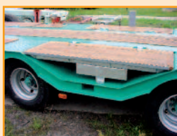
Klappbare Radmuldenabdeckung, separat entnehmbar
